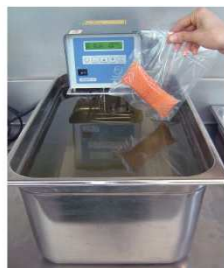
1. Colocación de salmón en un baño termostatzado (roner). Se cuece a 50 °C durante 15 minutos; se llega al corazón del producto entre 41 y 42 °C. Debe servirse de inmediato.
